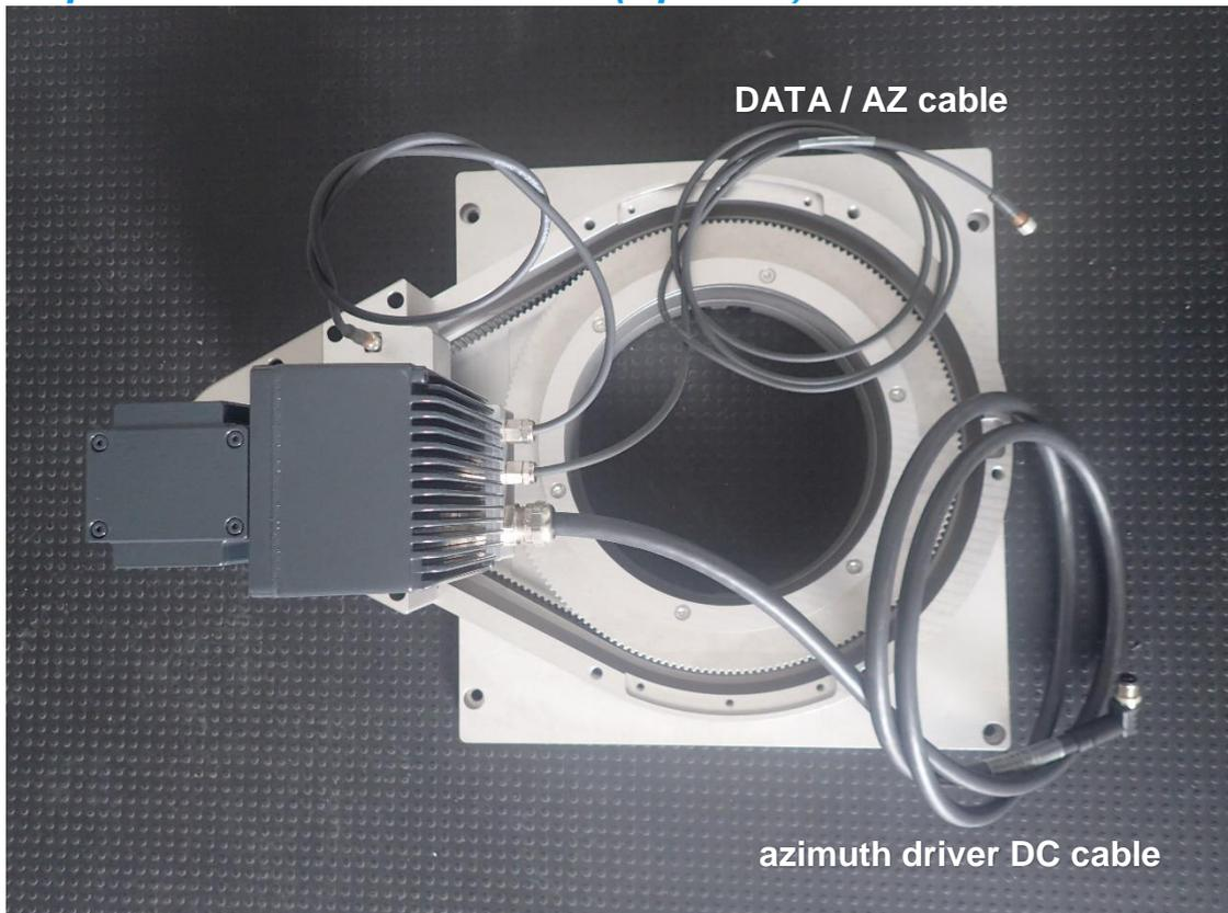
**Fig. 2.4.1.: Azimuth positioner**
